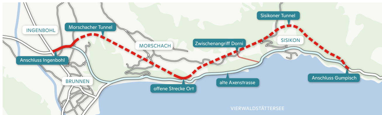
Das Projekt «A4 Neue Axenstrasse» besteht aus dem Morschacher und dem Sisikoner Tunnel. Dazwischen liegt die kurze offene Strecke.
